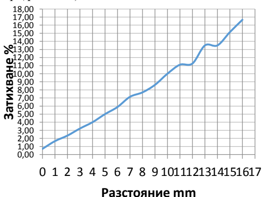
Фигура № 7. Затихване на измерения сигнал при директно осветяване на фотодетектора от диодите на пулсов оксиметър
