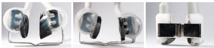
Фигура № 10. Различни изгледи на накрайник на пулсов оксиметър, модифициран за изследване на фронтални зъби
